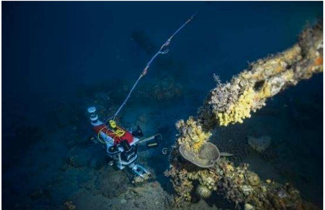
Le robot Speedy a pu tester une main anthropomorphe à trois doigts, à 90 m de profondeur, sur l'épave de la « Lune ». OSADA/SEGUIN/DRASSM
